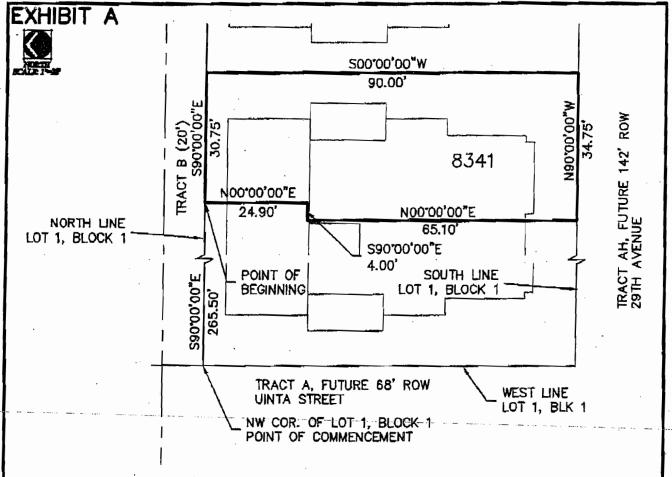
COMMENCING AT THE NORTHWEST CORNER OF SAID LOT 1, BLOCK 1, STAPLETON FILING NO. 5; THENCE S 90'00'00" E, A DISTANCE OF 265.50 FEET TO THE POINT OF BEGINNING; THENCE S 90'00'00" W, A DISTANCE OF 90.00 FEET; THENCE N 90'00'00" W, A DISTANCE OF 34.75 FEET; THENCE N 90'00'00" E, A DISTANCE OF 65.10 FEET; THENCE N 00'00'00" E, A DISTANCE OF 65.10 FEET; THENCE S 90'00'00" E, A DISTANCE OF 4.00 FEET; THENCE N 00'00'00" E, A DISTANCE OF 4.00 FEET; THENCE N 00'00'00" E, A DISTANCE OF 4.00 FEET;
