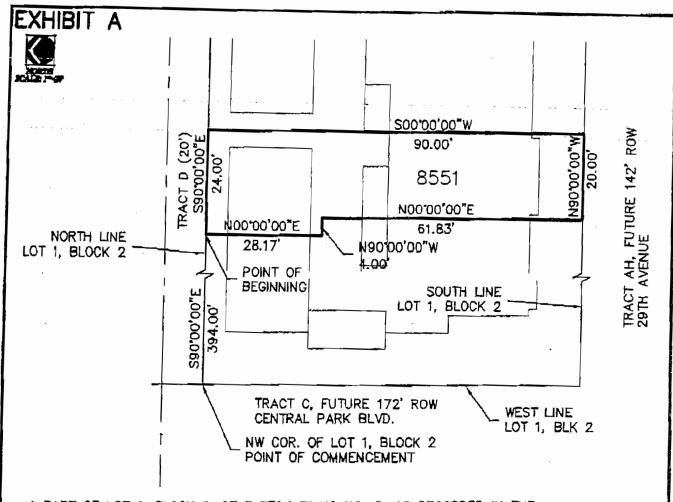
COMMENCING AT THE NORTHWEST CORNER OF SAID LOT 1, BLOCK 2, STAPLETON FILING NO. 5; THENCE S 90"00"00" E, A DISTANCE OF 394.00 FEET TO THE POINT OF BEGINNING; THENCE S 90"00"00" E, A DISTANCE OF 24.00 FEET; THENCE S 00"00"00" W, A DISTANCE OF 90.00 FEET; THENCE N 90"00"00" W, A DISTANCE OF 20.00 FEET; THENCE N 00"00"00" E, A DISTANCE OF 61.83 FEET; THENCE N 90"00"00" W, A DISTANCE OF 4.00 FEET; THENCE N 00"00"00" E, A DISTANCE OF 28.17 FEET TO THE POINT OF BEGINNING.
